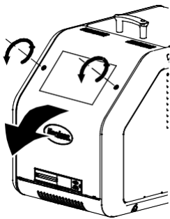
Abrindo a porta do compartimento elétrico
