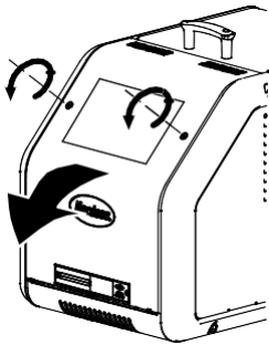
Abrindo a porta do compartimento elétrico
