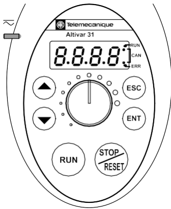
Teclado acionamento do motor (localizado no acionamento do motor dentro do gabinete elétrico)
